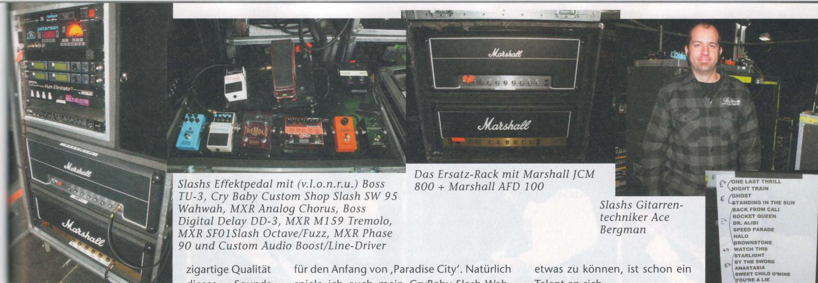
Das Haupt-Rack mit Marshall JCM 800 + Marshall AFD 100 plus Furman Power Conditioning, Peterson AutoStrobe, Shure UR4D, Ebtech Hum Eliminator, Whirlwind Multi Selector und Cry Baby Rack Wah
